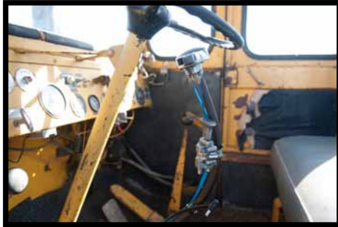
Bøyd girspak: Den ser ut til å stamme fra en gammel lastebil, girspaken med «rangeshift» og splitter.
