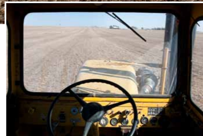
Sikt på panseret: Fra førerhuset er det god sikt, men blindvinkelen foran traktoren er likevel stor.
