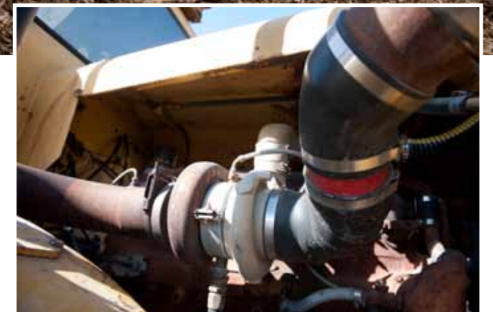
Ettermontert: Turboen ble ettermontert, denne modellen forlot fabrikkens uten turbo.
