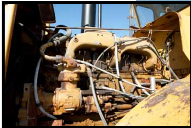
Seks på linje: Under panseret brummer en Cummins 220 hk dieselmotor med en fin gange. Motoren er av typen H-6-B.
